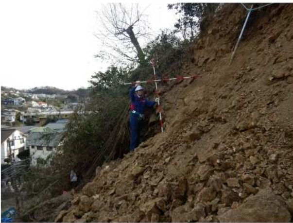
崩壊深:最大1.6m程度, 勾配1:1.4程度
