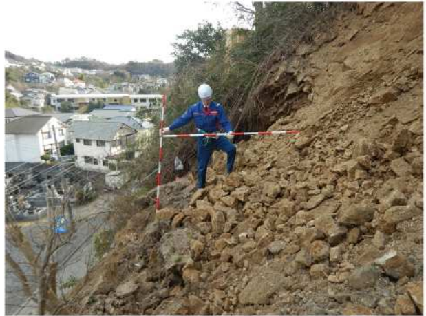
崩壊深:最大1.6m程度, 勾配1:1.4程度
